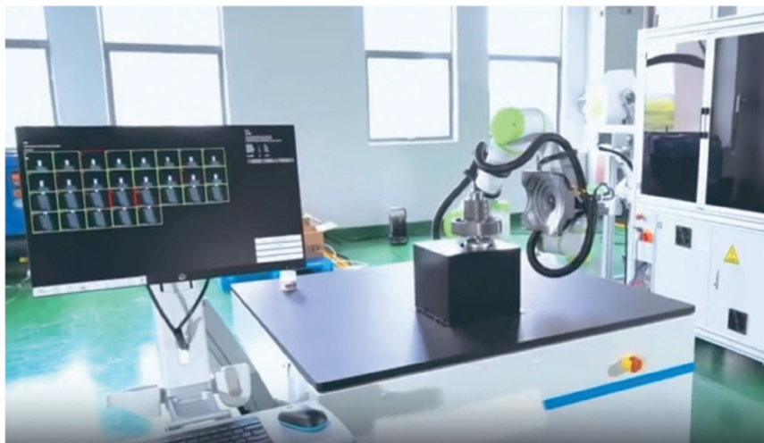
Роботизированная подача деталей в систему контроля
